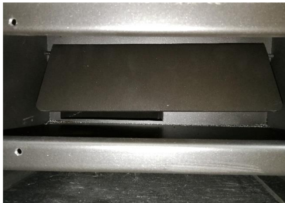
Billede 2: Tjek at røglederpladen sidder korrekt placeret på krogene.
